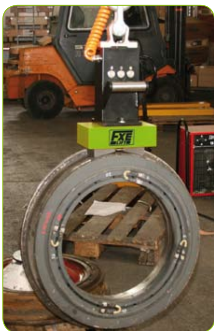
FXE mit Formpolschuh für Eisenbahnräder
