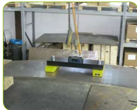
FXE-T zur Aufnahme von dünnen Blechen
