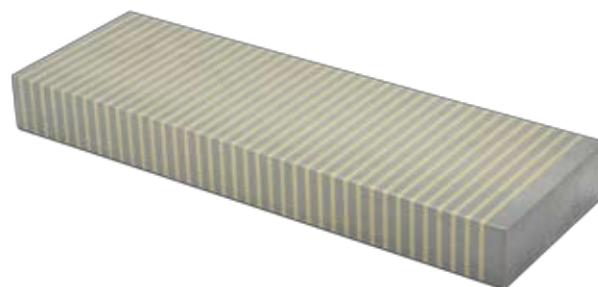
Lamellenauflegeplatten in Querspolteilung, silberhartverlötet in Polteilung 3+1mm
