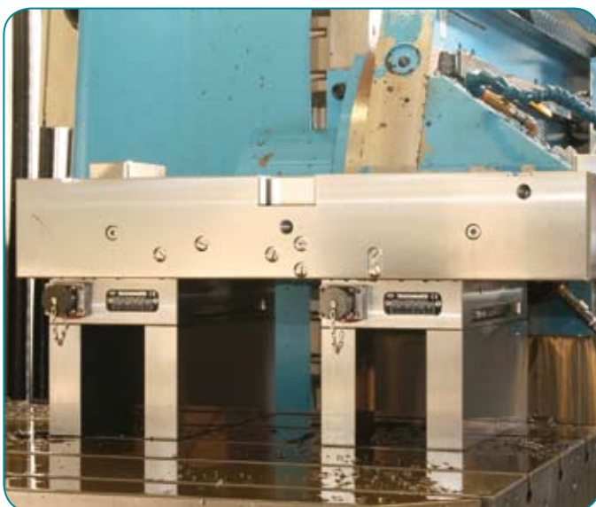
2 x QX HD 50 auf Säulen zum Tieflochbohren
