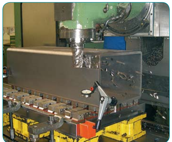
QX HD 50 mit Polverlängerungen zum vibrationsarmen Bearbeiten
