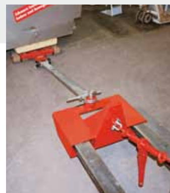
Die Rangierhilfe JRH 3 im Einsatz Forklift hitch JRH 3 in action
