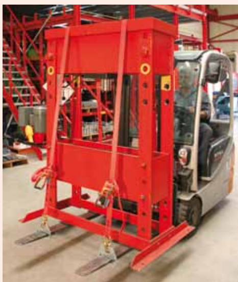
Ladungssicherung mit Gabelklemmen und Spanngurten
