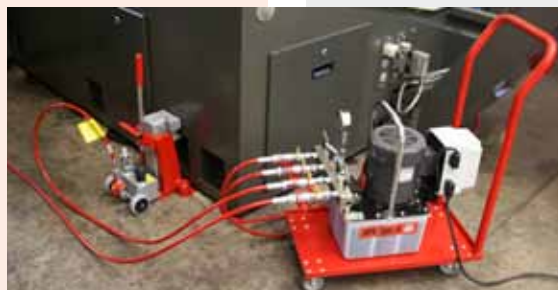
Elektropumpe JPE 30 NVR mit 2 Hebegeräten im Einsatz
