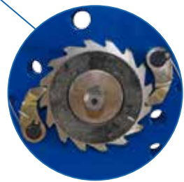
Sicherheitsbremse mit zwei Sperrklinken hält die Last zuverlässig
