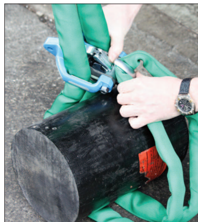
2) ... Schlaufe in den LUDWIG HOOK einhängen!
