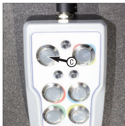
2) Erst jetzt läßt sich die Last lösen; dazu: Betriebstaste C und innerhalb 0,5 sec. auf die ...
