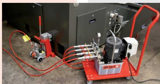
Elettropompa JPE 30 NVR con 2 binde in uso
